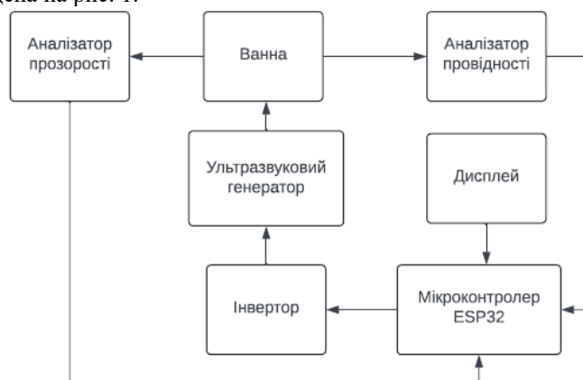
Рис. 1. Структурна схема системи керування процесом ультразвукового очищення
