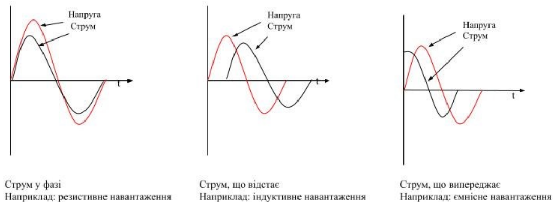
Рис. 4. Графіки напруги та струму для резистивного, індуктивного та ємнісного навантажень
