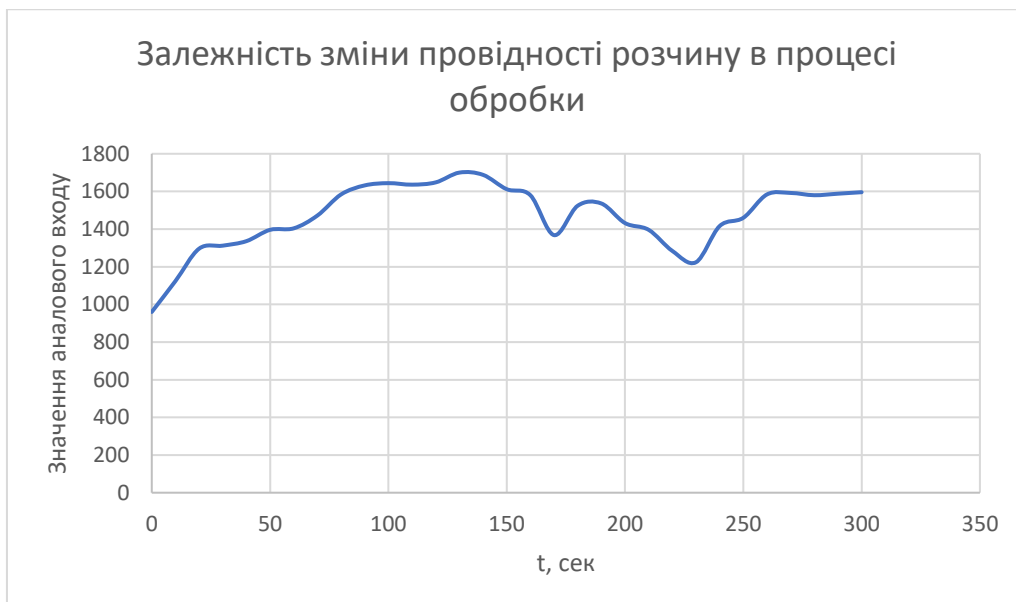
Рисунок 5. Залежність зміни провідності розчину в процесі обробки
