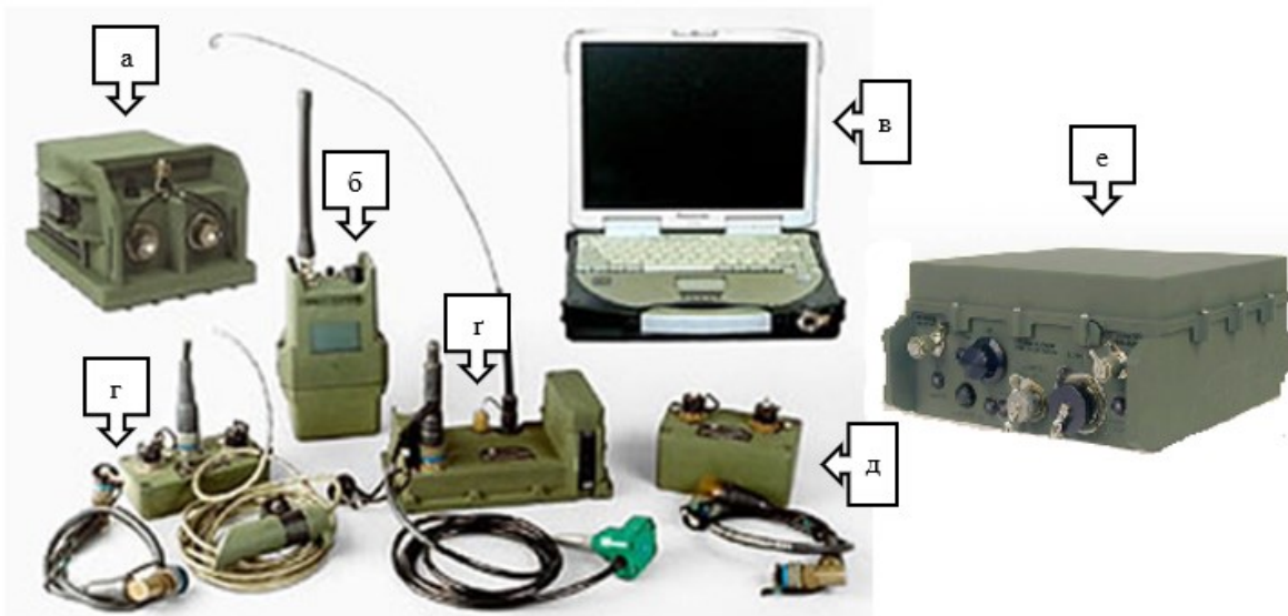
а) радіо ретранслятор RT-1175C/GSQ; б) компактний пристрій моніторингу, індексації та програмування AN/PSQ-16; в) польовий комп'ютер; г) інфрачервоний модуль МК-2967/GSR; р) сейсмоакустичний пристрій МК-2965/GSR; д) магнітний сенсорний модуль МК-2966/GSR; е) пристрій FPU
