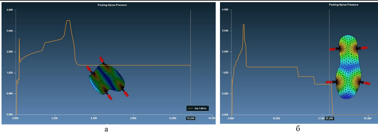
Рис. 3. Дослідження вплив тиску впорскування на час формування підшви за допомогою Moldex 3D: а - тиск впорскування 155 МПа; б - тиск впорскування 130 МПа
