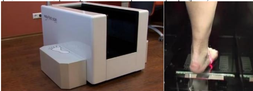
Рис. 5 - Сканування стопи з використанням 3D-сканера INFOOD
