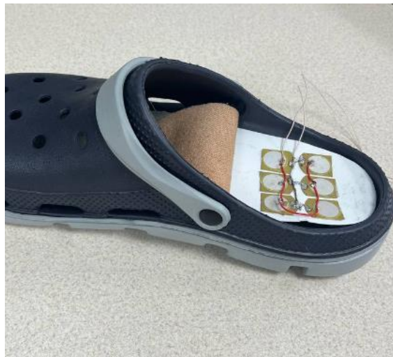
Рис. 11 - Зовнішній вигляд прототипу взуття з інтегрованими п'єзоелектричними генераторами
