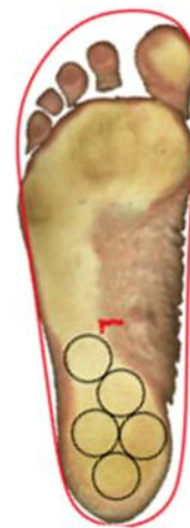
Рис. 8 – Схема розташування п'єзоелектронних генераторів на устілці з урахуванням найбільшої концентрації тиску в п'ятковій зоні стопи.
