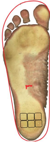
Рис. 9 - Схема розташування п'єзоелектронних генераторів зі зрізаними ділянками електрода на устіці з урахуванням найбільшої концентрації тиску в п'ятковій зоні стопи
