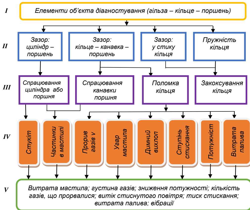
Рис. 1. Структурно – наслідкова діагностична модель для транспортних засобів
