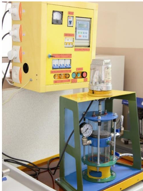
Рис. 1. Світлина дослідної установки для кавітаційної обробки водяно-бензинової паливної суміші для двигунів внутрішнього згоряння
