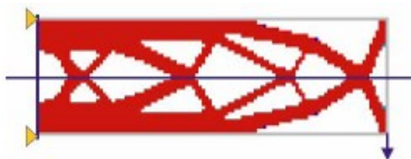
Рис. 4. Оптимізована конструкція балки з обмеженням половинної симетрії
