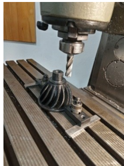
Рис. 16. Світлина оброблення фрезеруванням лисок h , установка заготовки здійснена торцем на стіл фрезерного верстату, фіксація прихватом через Т-подібні болти
