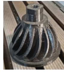
Рис. 13. Загальний вигляд деталі: а – 3D модель; б – деталь надрукована FDM без обробки
