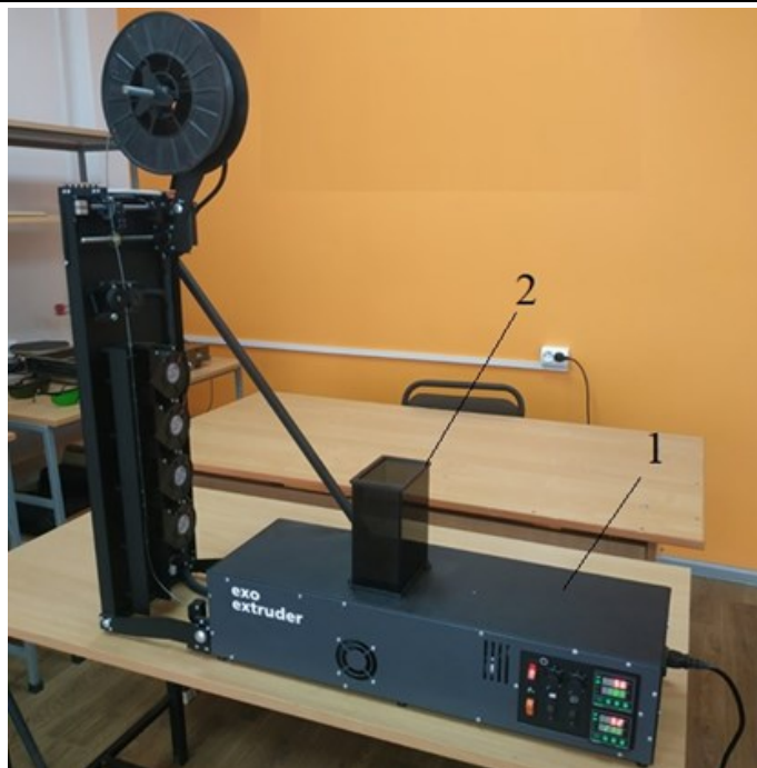
Рисунок 2 – Екструзійна машина: 1 - корпус з системою нагріву; 2 - блок завантаження
