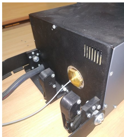
Рисунок 6 – Видавлювання розплавленого нейлону через фільеру екструзійної машини
