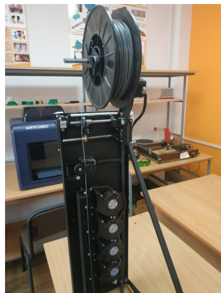
Рисунок 4 - Системи охолодження та намотування полімерної нитки
