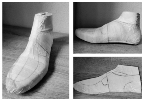
Рис.5. Процес проєктування ортопедичного взуття з урахуванням анатомічних особливостей стопи
