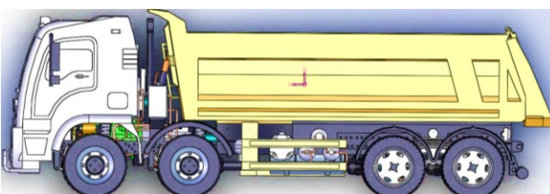
Рис. 6. Скріншот виду з боку складного рухомого об'єкта з навантаженням (гравій) та результати визначення маси та координат центру ваги
