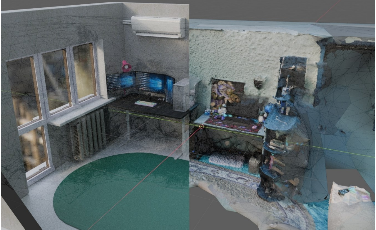
Рис. 2. 3D-сканування реального об'єкту та створення 3D-моделі цифрового двійника
