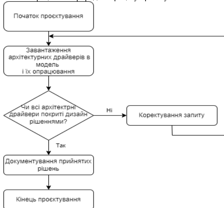
Рис. 2. Автоматизований процес проєктування архітектури
