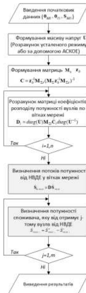
Рис. 1. Алгоритм визначення електроенергії споживача походженням від відновлювальних джерел енергії
