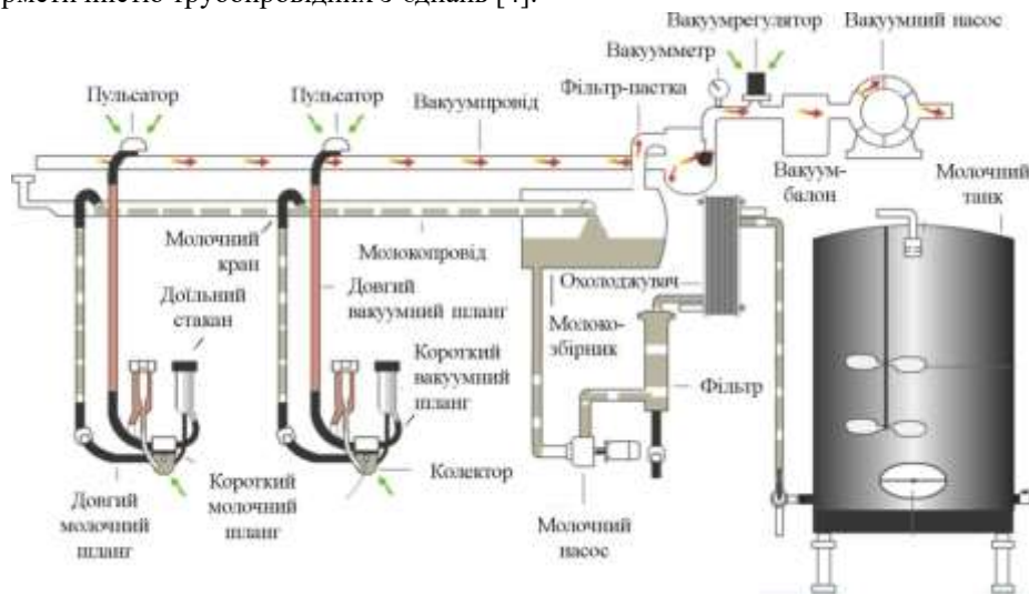
Рис. 3. Загальна схема доїльної установки
