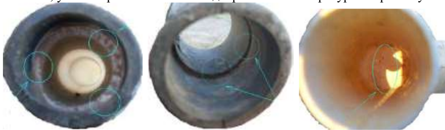
Рис. 2. Фрагменти механічних забруднень на окремих ділянках молокопровідних систем [2]
