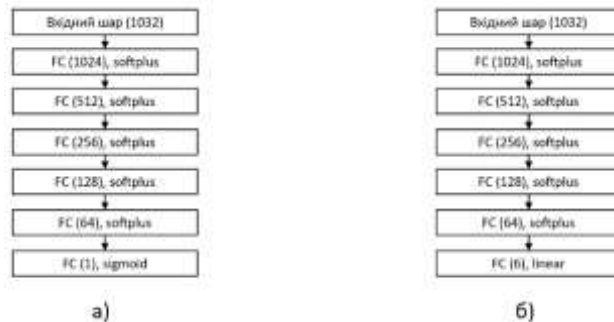
Рис. 2. Архітектури нейронних мереж: а) мережі-критика; б) мережі-актора. В скобках вказана кількість нейронів, поруч – функція активації (якщо її передбачено)
