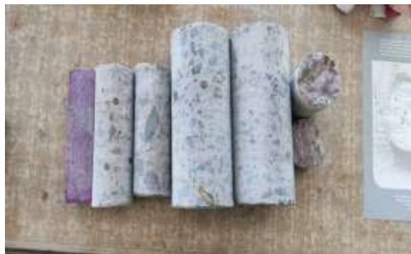
Рис. 1. Визначення ступеню карбонізації за допомогою фенолфталеїну та порівняння проектних зразків (кернів) до контрольного (паралелограм)
