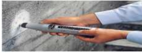
Рис. 2. Визначення міцності методом пружного відскоку за допомогою вимірювального пристрою «Молоток Шмідта»
