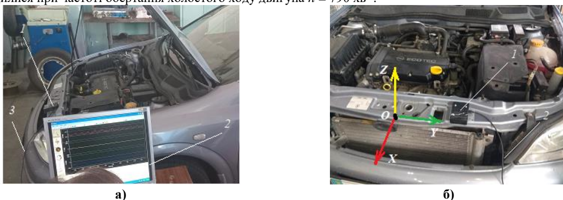
Рис. 1. Засоби вимірювання вібрацій: а – загальний вид моторного відсіку автомобіля із засобами вимірювання; б – розміщення осей координат напрямлення дії вібрацій; 1 – багатодатчиковий модуль; 2 – монітор; 3 – провід USB
