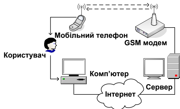
Рис. 1. Схема апаратної структури системи авторизації на основі голосового каналу зв'язку
