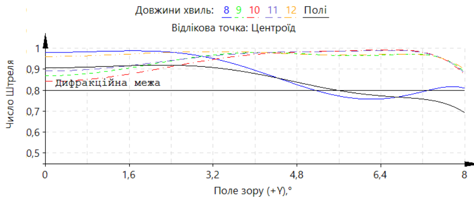
Рис. 6. Число Штреля інфрачервоного об'єктива F/0,85, 2\omega=16^\circ як функція кута поля
