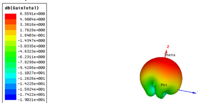
Рис. 3. Три-вимірна діаграма направленості patch-антени
