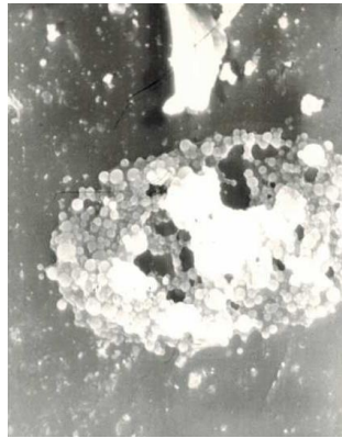
Рис. 4. Виділення пластифікатора на поверхні поліетиленової плівки, в склад якої введений інгібітор та пластифікатор, підданої старінню протягом 10 років. Виникнення колонії квазікристалічних шароподібних утворень вказує на значну дефекти матеріалу, через які на поверхню проходять виділення незв'язаних із матрицею додатків X 2000.
