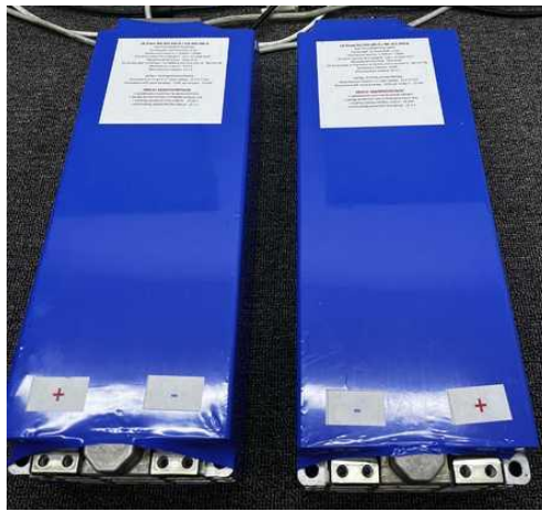
Рис. 3. Дві акумуляторні Li-іон батареї 6S2p смістю 125 А·год (5,55 кВт·год)
