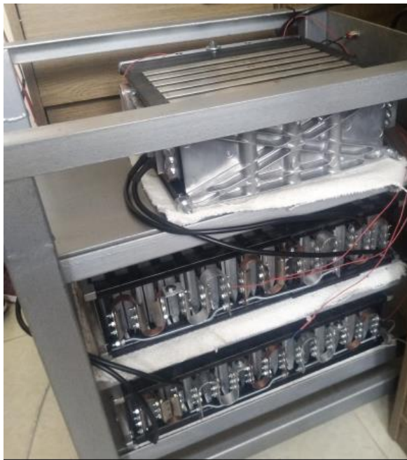
а) SHE з акумуляторною батареєю ємністю 426 А·год з робочою напругою 48 В (20,49 кВт·год)
