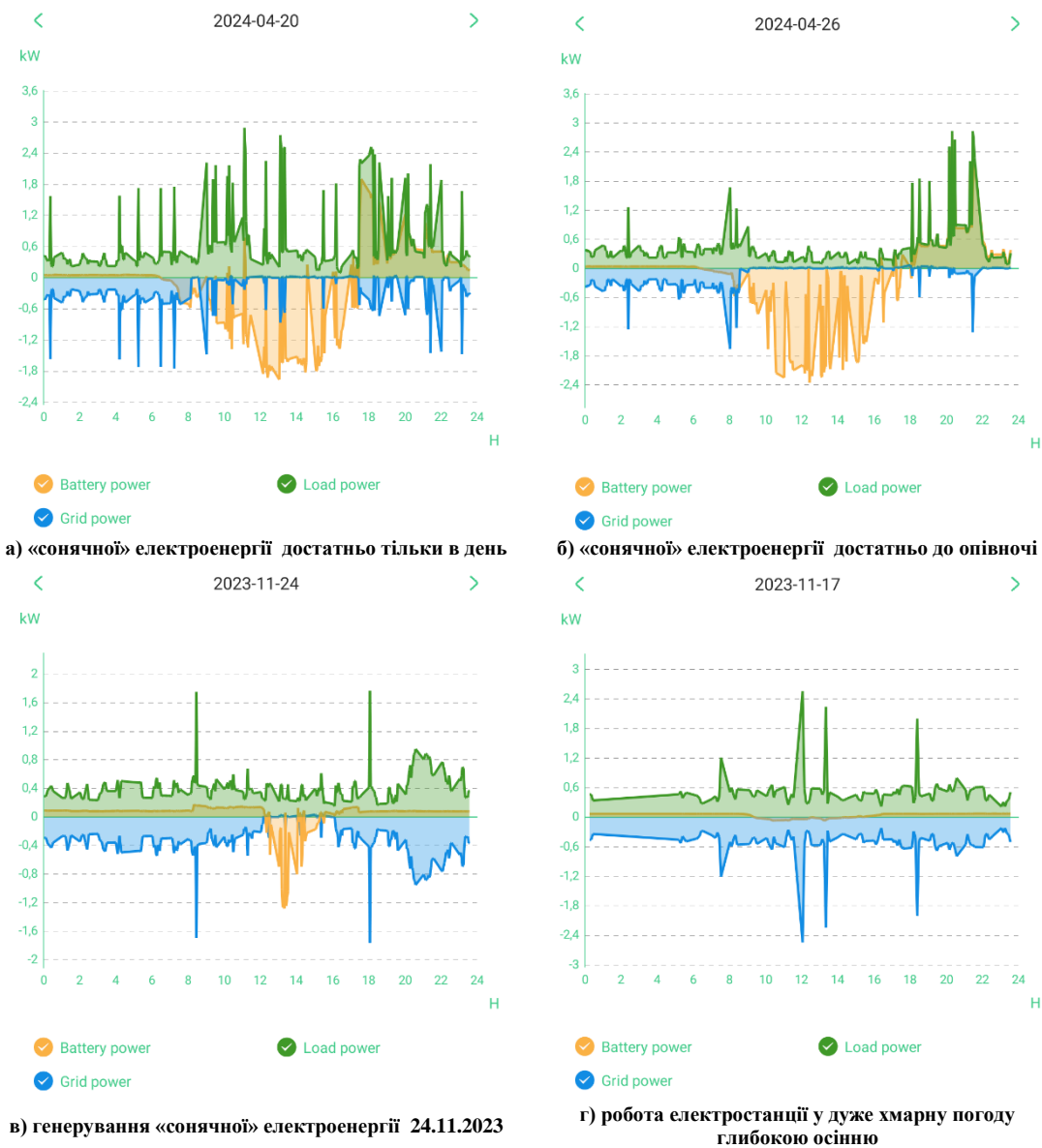
Рис. 4. Графіки енергоспоживання та зарядки СНЕ отримані експериментальним шляхом
