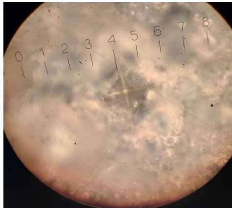
Рис. 4. Поверхня зразка з відбитком від алмазного конуса
