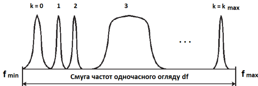
Рисунок 3. Спектри радіосигналів, які одночасно приймає панорамний приймач [3]
