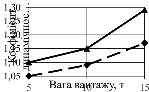
Рис. 3. Коефіцієнти динамічності при підйомі вантажу у режимі з „ваги” (штрихова лінія) та з „підхопленням” (суцільна лінія)
