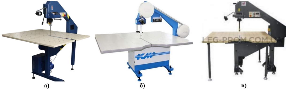
Рис. 4. Стаціонарні стрічкові розкрійні машини: а) HOFFMAN HF-200 T/500/1; б) KNITISM KB KBK-900S; в) REXEL R1000
