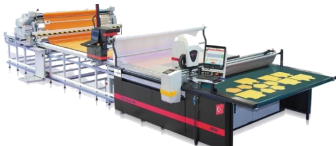
Рис. 6. Автоматичний розкрійний комплекс конвеєрного типу Serkon Makina MC 90 (Польща) з вакуумною установкою
