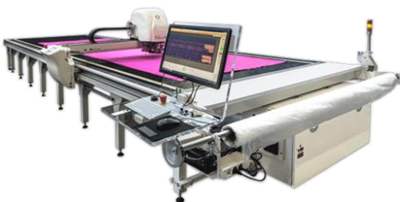
Рис. 5. Автоматичний розкрійний комплекс F.K. Group Biliardo 25-60-80 (Італія) стаціонарного типу з вакуумною установкою
