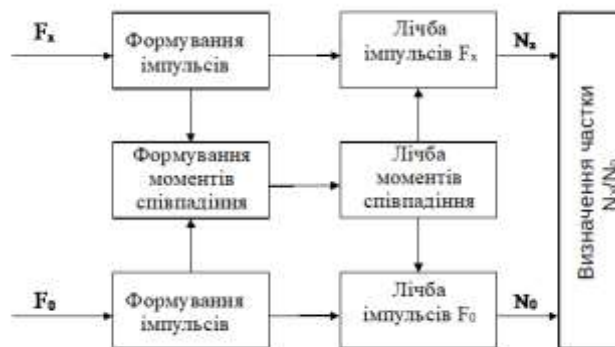
Рис. 2. Схема процесу вимірювання частоти за допомогою методу подвійного співпадіння
