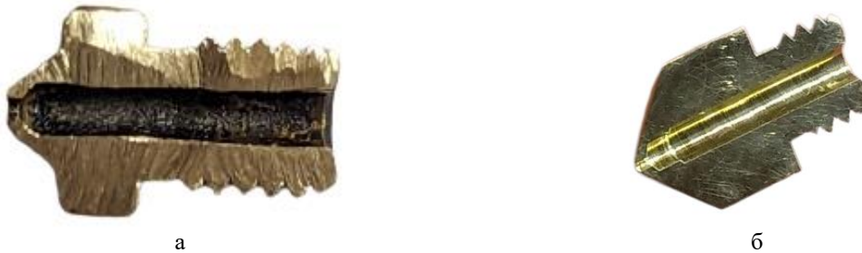
Рис. 3. Сопло в розрізі: а – з циліндричним та конічним каналом; б – з додатковим циліндричним каналом
