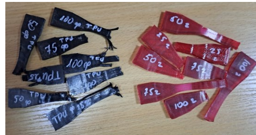
Рис.24. Зразки ABS та TPU пластиків після статичного випробування на розтяг виготовлені з філаменту та подрібнених часток полімеру: а-ABS; б-TPU
