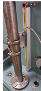
Рис.7. Оптичний лінійний енкадер ASD
