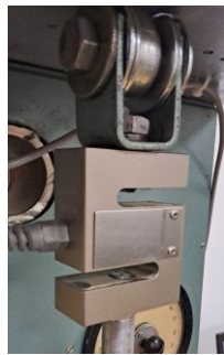
Рис.6. Тензометричний датчик TedeA 619 фірми Vishay
