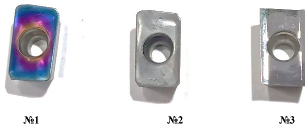
Рис. 2 Змінні пластинки для встановлення у корпусі торцевої фрези PE01.11B32.100.10
