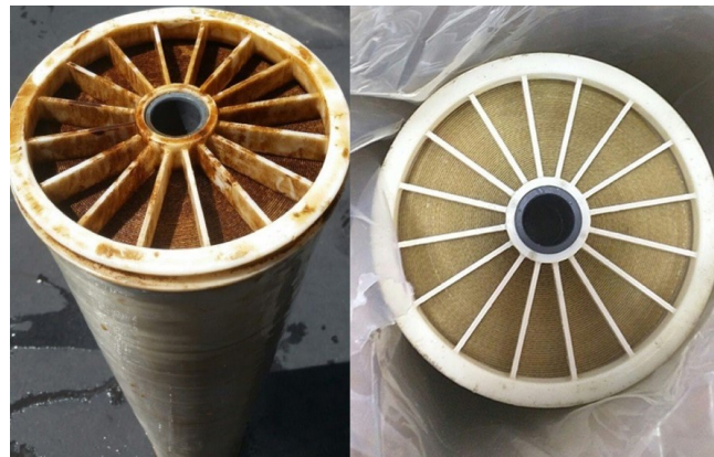
а) б) Рис. 1. Вигляд забрудненої (а) та очищеної (б) мембрани Filmtec Джерело: фото автора.
