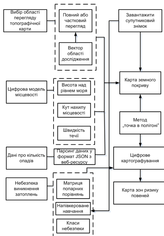
Рис. 1. Структурна схема методології цифрового картографування виникнення можливих затоплень території
