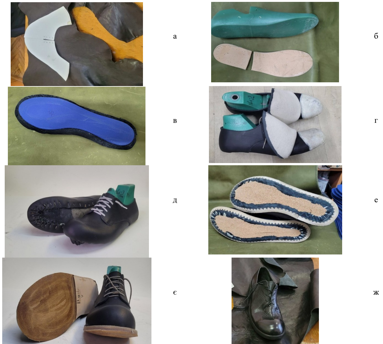
Рис. 4. Основні виробничі операції створення індивідуального анатомічного взуття (стиль гранж):
