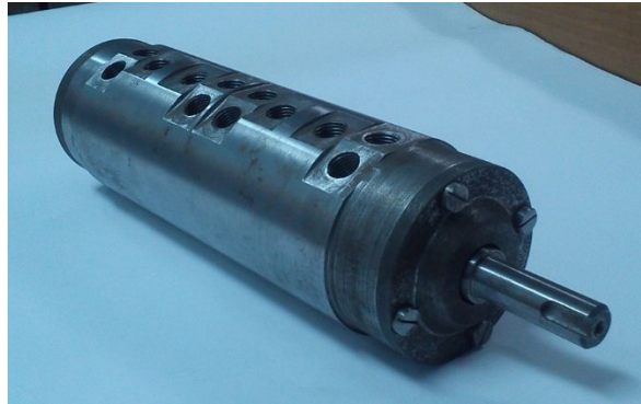
Рис. 4. Експериментальний зразок гідравлічного розподільника руху рідини на гідродвигуни плісирувальної машини
