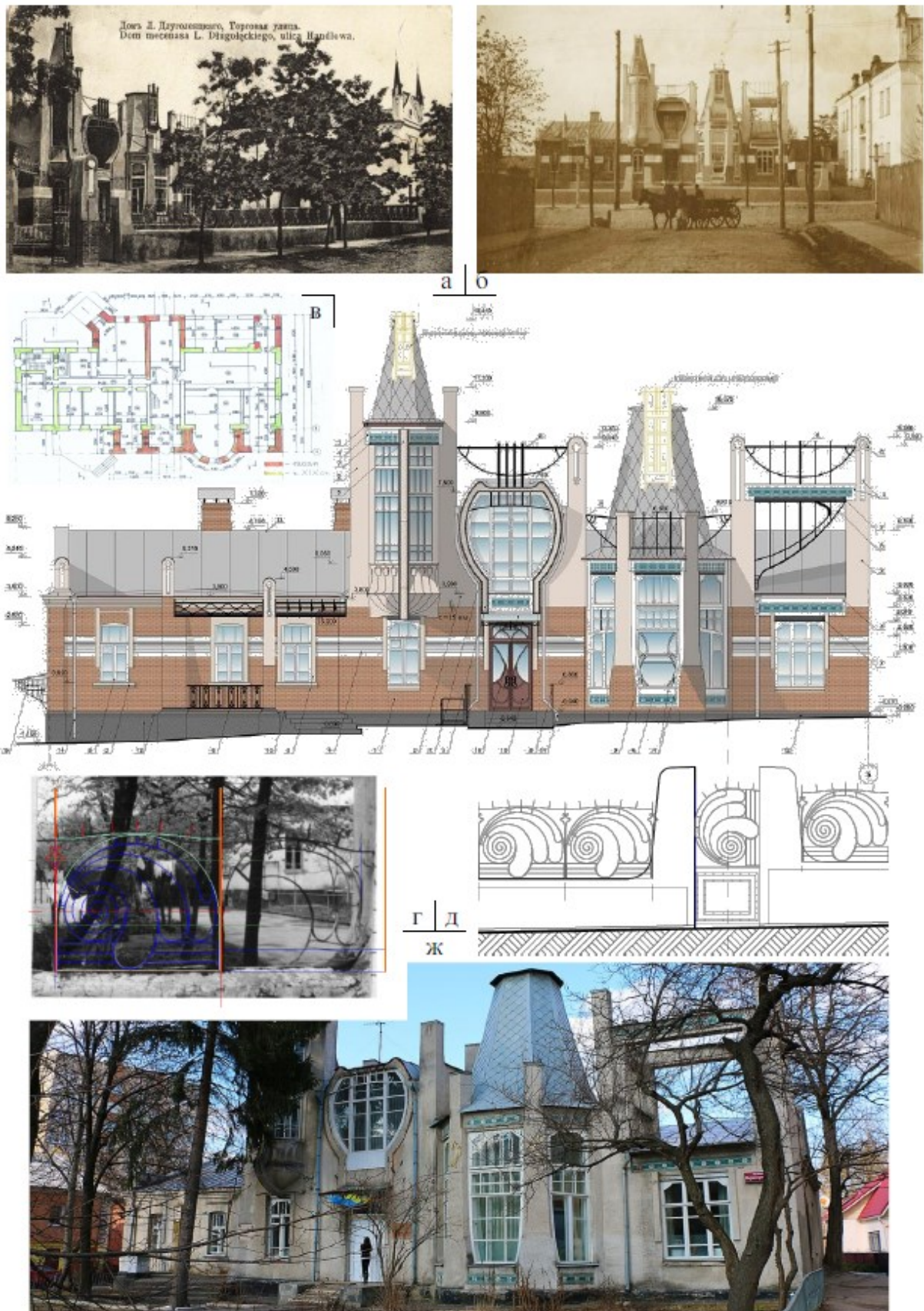
Рис.1. а) Будинок Длуголенського поштівка; б) Фото будинку в перспективі вул. арх. Артинова; в) Схема плану реконструкції; г) Фрагмент огорожі; д) Креслення реставрації; ж) Фото [12], [13].
