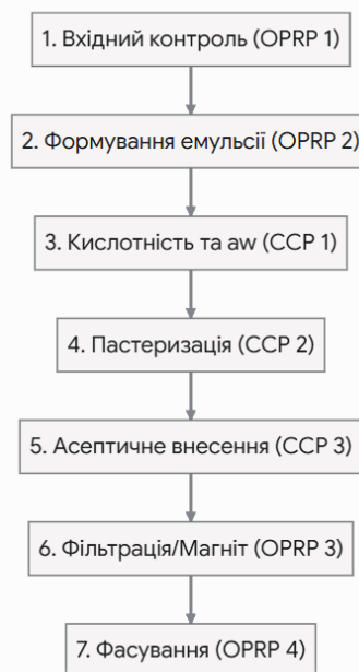
Рис. 1. Принципова схема технологічного процесу виробництва функціональних соусів з інтегрованою системою контролю небезпечних чинників (НАССР)
