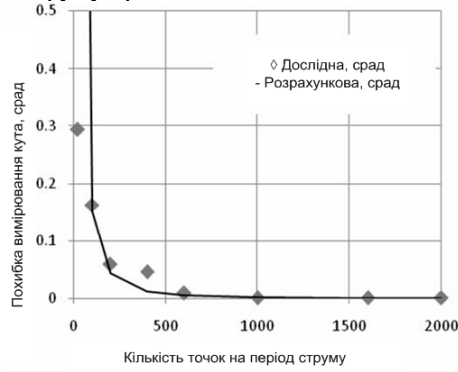
Рисунок 6. Графік залежності розрахункової погрішності вимірювання \text{tg}\delta_1 від числа точок дискретизації на період промислової частоти 50 Гц з нанесеними точками результатів вимірювань отриманих дослідним шляхом середньої похибки (за наслідками 50 вимірювань)
