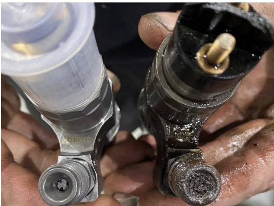
Рис. 4. Порівняння “чистої” та “забрудненої/пошкодженої” форсунки
