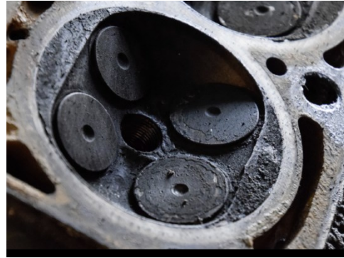
Рис. 3. Нагароутворення та відкладення на елементах циліндро-поршневої групи
