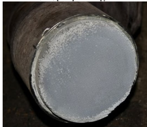
Рис. 5. Забруднений (закоксований) каталізатор
