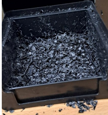
Рис.5. Подрібнений PETG-матеріал після проходження через шредер
