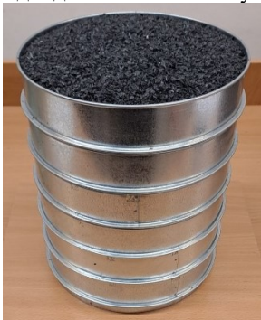
Рис.6. Набір сит для ситового аналізу
