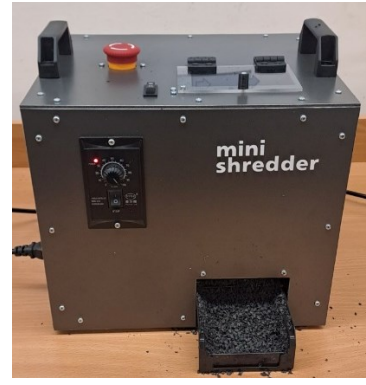
Рис.2 Загальний вигляд шредера для подрібнення PETG-відходів
