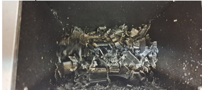
Рис. 4. Процес подрібнення ножами відходів PETG-пластику
