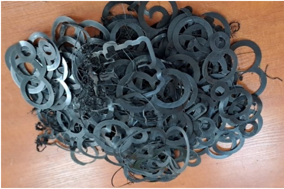
Рис.1. Вихідні відходи PETG-пластику, що утворюються під час FDM 3D-друку
