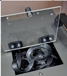
Рис.3. Процес завантаження пластикових відходів у бункер шредера
