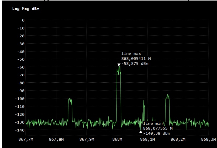
Рис. 7. Вигляд спектру прийнятого сигналу в один з моментів передавання тестового сигналу
