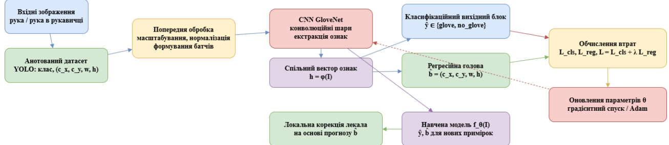
Рис. 1. Архітектура та принцип роботи запропонованої моделі інтелектуальної корекції лекала рукавички (побудовано авторами)
