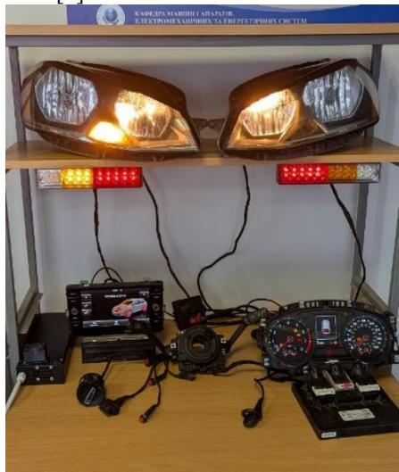
Рис.3. Режим роботи установки з увімкненим денним ходовим вогнем та покажчиком повороту
