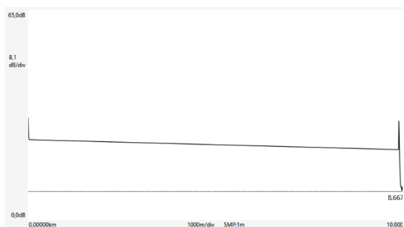
Рис. 4. Приклад рефлектограми однорідної ділянки оптичного волокна
