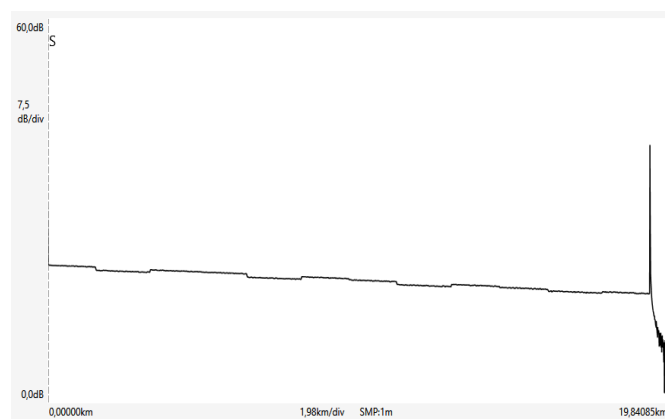
Рис. 1. Рефлектограма змонтованої волоконно-оптичної лінії зв'язку
