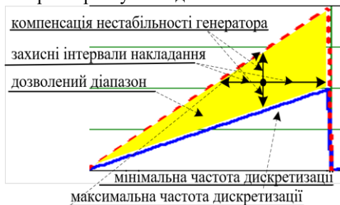
Рис. 15. Вибір частоти дискретизації з урахуванням захисних інтервалів
