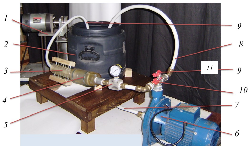
Рис. 9. Загальний вигляд дослідної установки для зміни властивостей водопровідної води: 1 – вібраційний кавітатор; 2 – ємність з водою; 3 – вузол омагнічування статичним магнітним полем з градієнтом напруженості вздовж потоку рідини; 4 – статичний кавітатор; 5 – манометр; 6 – насос з електродвигуном; 7 – трубопровід від бака до насоса; 8 – зливний трубопровід від насоса до бака; 9 – трубопровід напірний
