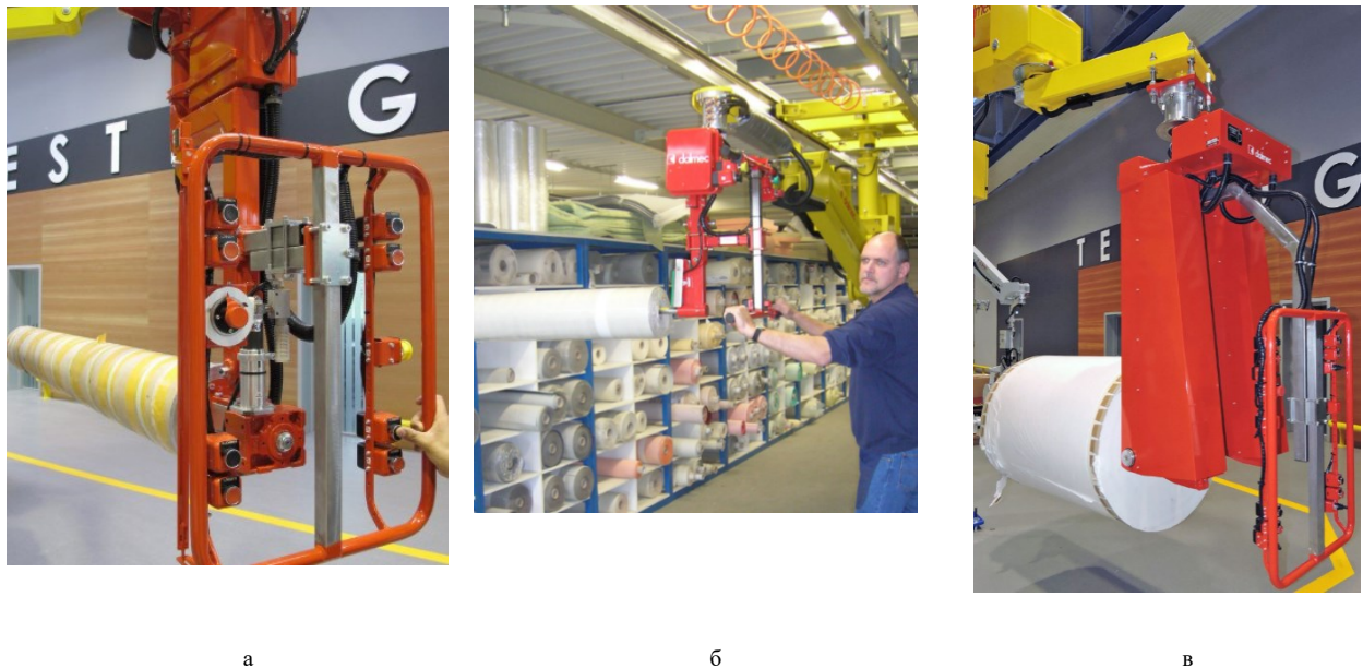
Рис. 2. Робототехнічні пристрої Dalmec Partner різних конструкцій: а — з розширюваним захоплювальним пристроєм; б — з верхнім підвісним кріпленням; в - з розширюваним патроном
