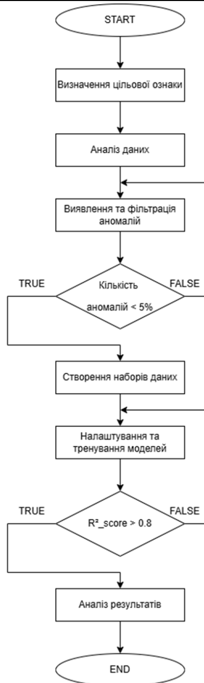
Рис. 6. Блок-схема алгоритму прогнозування рівнів води для гідропостів басейну Дністра
